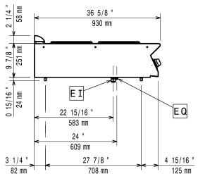
Electrical inlet (power) FΩ **Equipotential screw**
